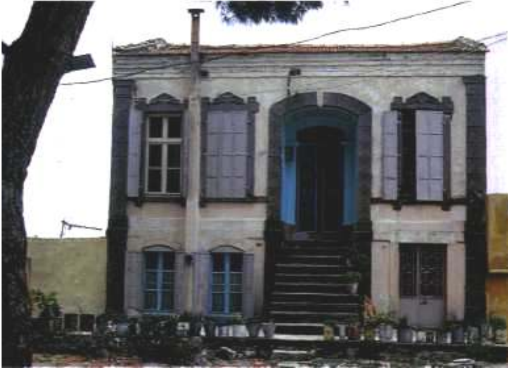
Resim 52- Bitişik düzene göre tasarlanmış bir evin cephesini sınırlayan, iki kat yüksekliğinde ve taşları 4 yöne eğimli işlenmiş pilaster (Domuz Alanı)
